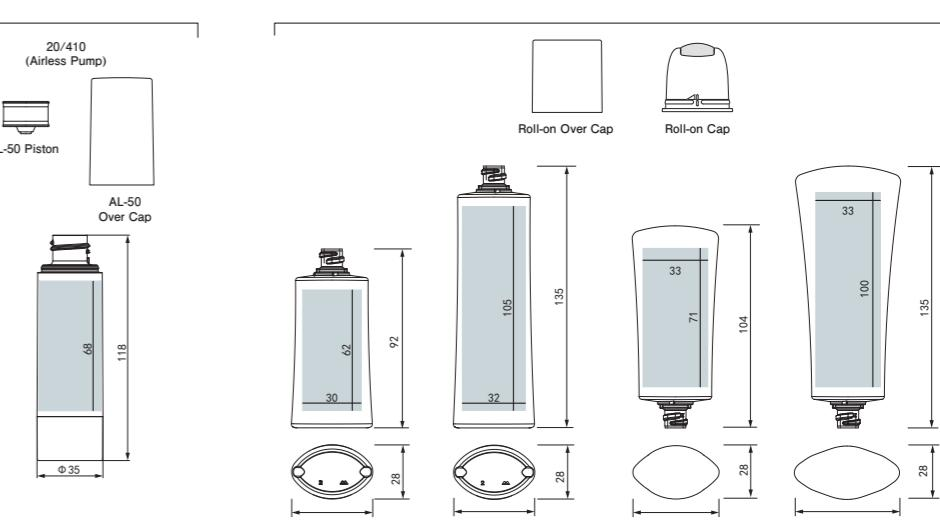
ROLLON-50      ROLLON-80      ROLLON-50D      ROLLON-80D
